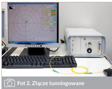
Fot 1. Proces strojenia złącz
