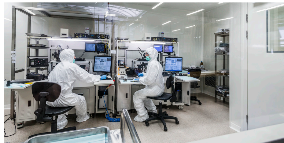
Rys. 3. Produkcja spliterów - Clean Room Cellco Tech Group
