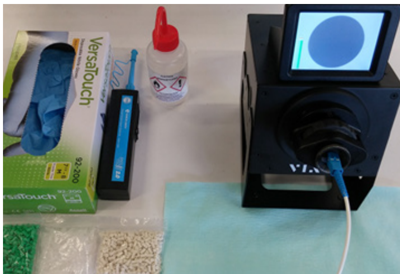
Rysunek 5. Stanowisko do inspekcji złącz CELLCO.
